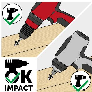
V prípade inštalácie skrutiek použitých na konštrukčné spoje drevo-drevo (softwood) možno použiť aj rázový/príklepový skrutkovač.
