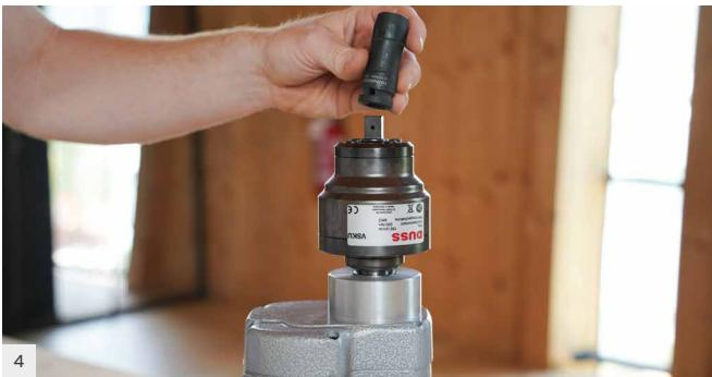
Objímku (ATCS007 alebo ATCS008) založte na adaptér s bezpečnostnou spojkou (DUVSKU). Použiť môžete aj jednoduchý adaptér (ATCS2010).
