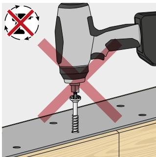
Použitie rázového/príklepového skrutkovača nie je povolené.
