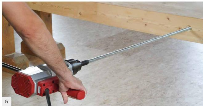
Objímku založte na závitovú tyč a adaptér založte na skrutkovač. Pre lepšiu kontrolu a stabilitu počas skrutkovania odporúčame použiť rukoväť (DUD38SH).
