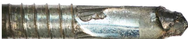
Roztavenie hrotu počas montáže na veľmi tvrdú platňu bez dištančných prvkov medzi drevom a platňou.
