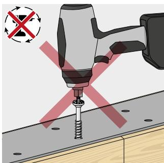
Použitie rázového/príklepového skrutkovača nie je povolené.
