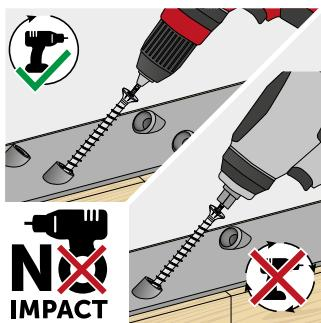
Použitie rázového/príklepového skrutkovača nie je povolené.
