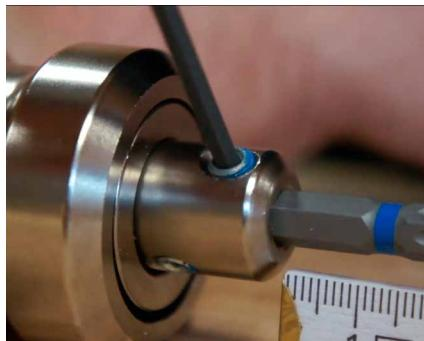
Bit vložte do skrutkovacej pomôcky CATCH a upevnite do správnej hĺbky v závislosti od vybraného konektora.
