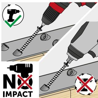
Použitie rázového/príklepového skrutkovača nie je povolené.
