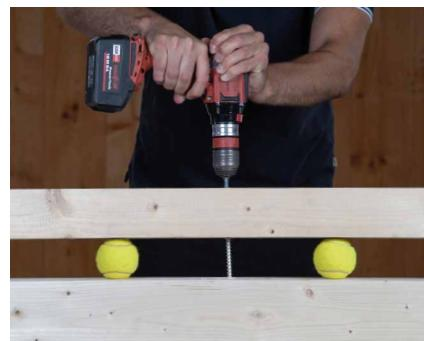
Skrutka s celkovým závitom (napr. VGZ) prenesie silu s využitím axiálnej odolnosti a zavŕta sa do drevených prvkov bez toho, aby sa pohli.
