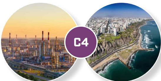
**Trieda atmosférickej korózie C4:** oblasti s vysokým obsahom znečisťujúcich látok, solí a chloridov. Príkladom sú mestské a priemyselné oblasti s vysokým znečistením a prímorské oblasti.
