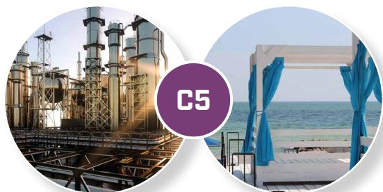
**Trieda atmosférickej korózie C5:** oblasti s veľmi vysokou koncentráciou solí, chloridov alebo korozívnych činidiel z výrobných procesov. Príkladom sú morské oblasti alebo oblasti s vysokým priemyselným znečistením.
