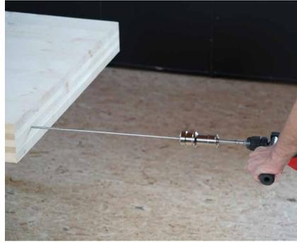
O CATCH é adequado para conectores longos em que, de outra forma, a ponteira teria tendência a sair do espaço da cabeça do parafuso.
