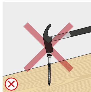
Não martelar os parafusos para inserir a broca na madeira.
