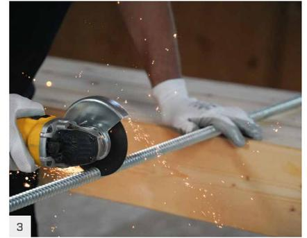
Cortar a varão rosçado RTR com o comprimento desejado, assegurando que é inferior à profundidade do pré-furo.
