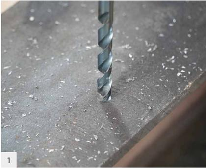
1 Fazer um furo de diâmetro  $D_F = 20$  mm na chapa metálica no ponto de engate da anilha HUS815.
