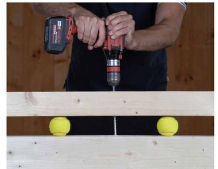
O parafuso de rosca total (por ex., VGZ) transfere a força explorando a sua resistência axial e penetra no interior dos elementos de madeira sem se deslocar.
