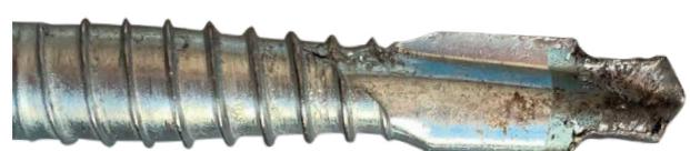
Redução da ponta ao perfurar a chapa devido à elevada dureza da chapa.
