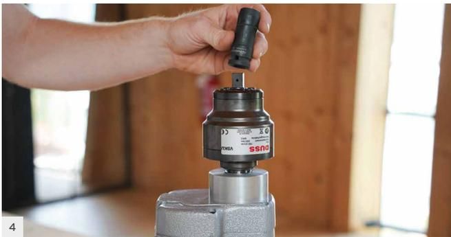
Montar a manga (ATCS007 ou ATCS008) no adaptador com fricção de segurança (DUVSKU). Em alternativa, pode ser utilizado um adaptador simples (ATCS2010).
