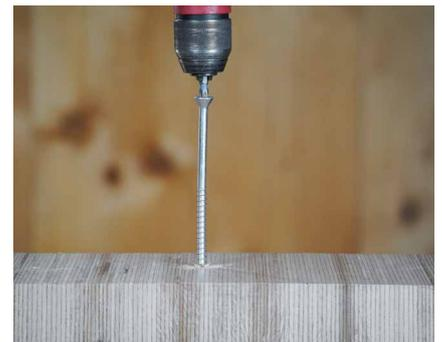
Em alternativa, podem ser utilizados parafusos específicos para aplicações em madeiras duras (por ex., HBSH), que podem ser inseridos sem a ajuda de um pré-furo.
