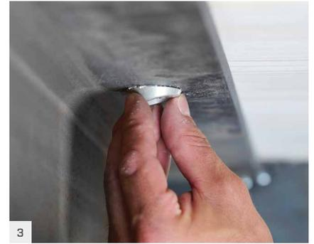
3 Remover o liner e aplicar a anilha no furo, prestando atenção à direção de inserção.
