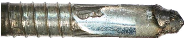
A ponta derreteu durante a instalação numa chapa demasiado dura sem espaçadores entre a madeira e a chapa.
