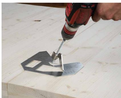
Pour assurer un positionnement et une inclinaison corrects des vis VGZ, il est conseillé d'utiliser le gabarit JIGVGZ45 positionné à 45° par rapport à la tête du panneau.
