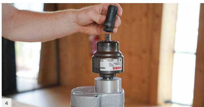
4 Assembler le manchon (ATCS007 ou ATCS008) sur l'adaptateur avec embrayage de sécurité (DUVSKU). Il est également possible d'utiliser un adaptateur simple (ATCS2010).
