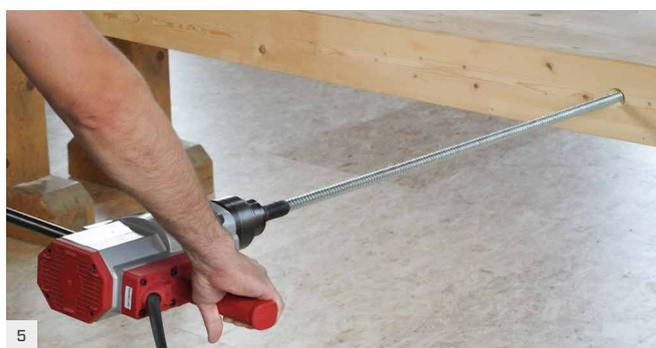
5 Insérer le manchon dans la tige filetée et l'adaptateur sur la visseuse. Nous recommandons l'utilisation de la poignée (DUD38SH) pour plus de contrôle et de stabilité lors du vissage.
