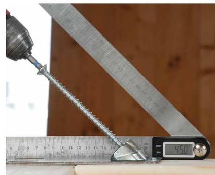
Pour assurer le contrôle du moment de torsion appliqué, il est nécessaire d'utiliser le bon modèle de TORQUE LIMITER en fonction du connecteur choisi.
