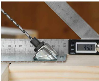
Le gabarit JIG VGU permet de réaliser facilement un pré-perçage avec une inclinaison de 45°, facilitant le vissage de la vis VGS dans la rondelle. La longueur préconisée du pré-perçage est d'au moins 20 mm.
