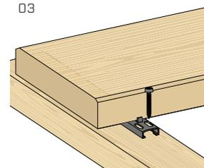
Visser chaque connecteur à la sous-structure par une vis KKTX implantée dans l'un des deux trous oblongs.
