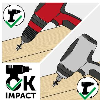
En cas de pose de vis utilisées pour des assemblages structuraux bois-bois (softwood), il est également possible d'utiliser une visseuse à impulsions / percussion.
