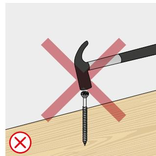
Ne pas frapper sur les vis pour insérer la pointe dans le bois.
