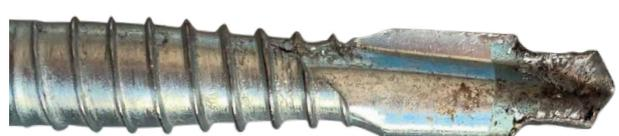
Réduction de la pointe lors du perçage de la plaque due à la dureté élevée de la plaque.
