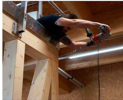
Utile en cas de vissages dans les coins, qui ne permettent généralement pas d'exercer une grande force de vissage.
