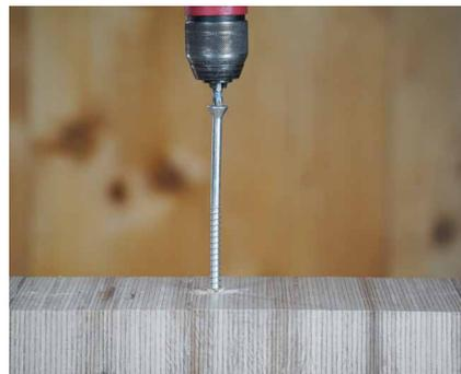
Il est également possible d'utiliser des vis spécifiques pour bois durs (par ex. HBSH), qui peuvent être insérées sans pré-perçage.
