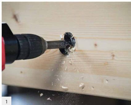
1 Pour une meilleure finition, il est recommandé de percer un trou à l'aide de BOR-MAX pour y loger le bouchon en bois.
