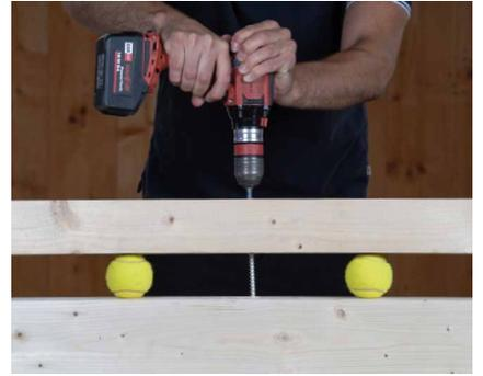
全螺纹螺钉（例如 VGZ）通过利用其轴向强度来传递力，并穿透木构件内部而不产生位移。
