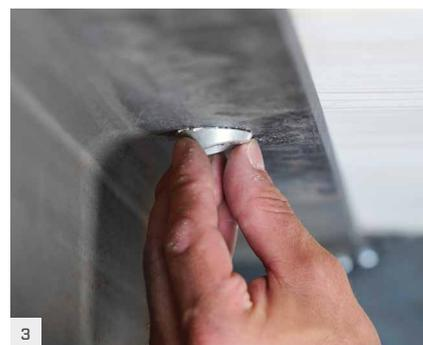
3 撕下离型纸，并将垫圈套在孔上，注意插入方向。
