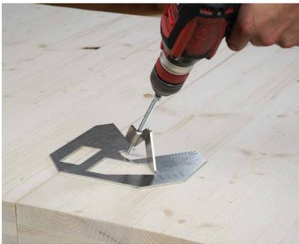
为了确保 VGZ 螺钉的正确定位和倾斜度，我们建议使用与面板头部成 45° 度的 JIGVGZ45 模板。
