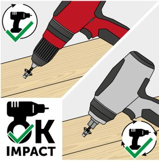
在安装用于木-木结构连接 (softwood) 的螺钉时, 也可以使用脉冲型电钻/冲击钻。
