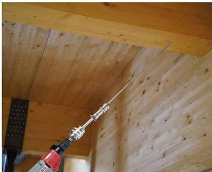
借助 CATCH，即使是最长的螺钉也可以快速安全地拧紧，而不会出现钻头打滑的风险。可配套 扭矩控制器使用 TORQUE LIMITER。
