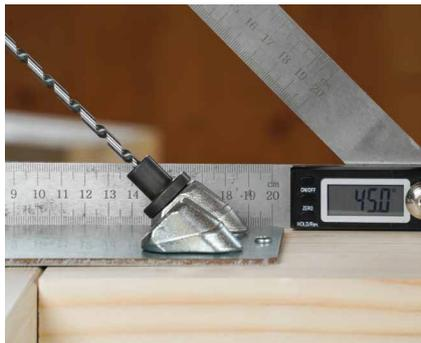
JIG VGU 模板可让您轻松准备 45°角预钻孔，从而便于随后将 VGS 螺钉拧入垫圈内。建议预钻孔长度至少为 20 mm。
