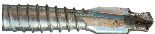
由于板材硬度高，在板材钻孔时尖端会减少。
