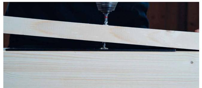
更大的孔可防止金属钻孔时木构件从金属板上抬起。
